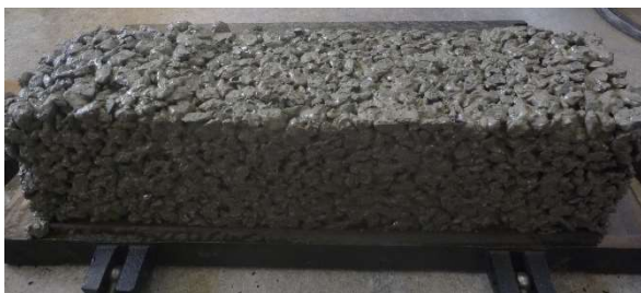
写真-4 フレッシュ性状の確認方法（側面） 写真-5 フレッシュ性状の確認方法（底面）
